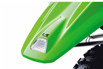
Компактный и экономичный задний фонарь на светодиодах
