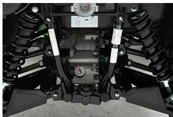
Независимая задняя подвеска (IRS) с двойным поперечным рычагом
