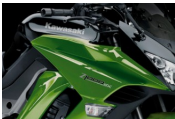
Объемный топливный бак вместимостью 19 литров
