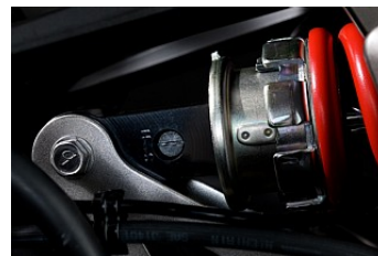
Задняя подвеска с горизонтальным креплением рычага
