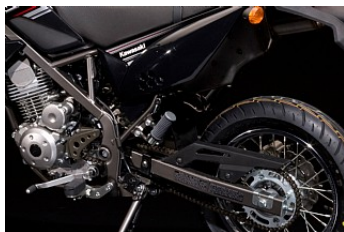
Высокопрочная периметральная рама, специально разработанная
