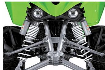
Мощная передняя подвеска с пружинами переменной жесткости
