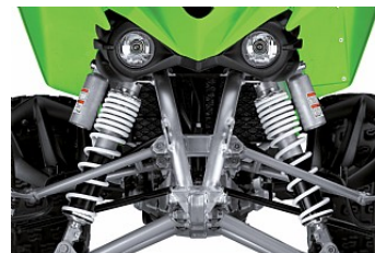
Мощная передняя подвеска с пружинами переменной жесткости
