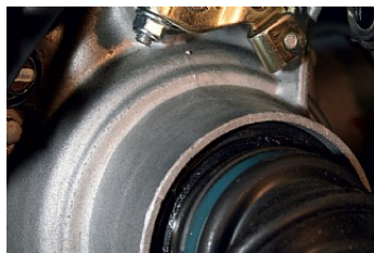
Регулируемый самоблокирующийся передний дифференциал
