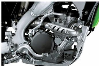
4-тактный одноцилиндровый двигатель объемом 249 см<sup>3</sup> с жидкостным охлаждением
