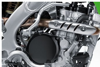
449 кубовый, 4-х тактный, одноцилиндровый двигатель с жидкостным охлаждением
