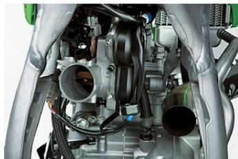
Система впрыска топлива, не зависящая от аккумулятора
