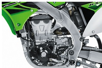
499 кубовый, 4-х тактный двигатель с жидкостным охлаждением и топливным
