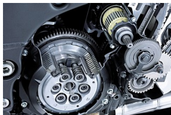
Регулируемое сцепление с фиксацией обратного крутящего момента
