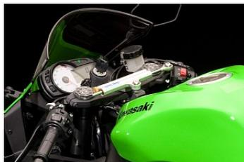
Амортизатор рулевого механизма
