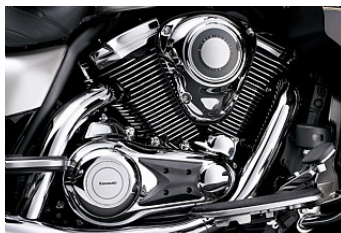
Мощный V-образный двухцилиндровый двигатель объемом 1700 см 3
