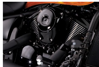
Двигатель объем 903 см3 с жидкостным охлаждением
