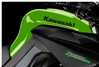
Объемный топливный бак вместимостью 19 литров
